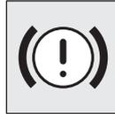
Esta luz se ilumina cuando el interruptor de encendido se gira a la posición "ON" (Encendido) o el modo de funcionamiento se pone en ON, y se apaga luego de unos segundos.
