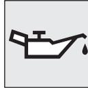
Esta luz se ilumina cuando el interruptor de encendido se gira a la posición "ON" (Encendido) o el modo de funcionamiento se pone en ON, y se apaga una vez que arranca el motor. Si se enciende mientras el motor está en funcionamiento, la presión del aceite está demasiado baja. Si la luz de advertencia se enciende con el motor en marcha, apague el motor y póngase en contacto con el distribuidor autorizado de MITSUBISHI MOTORS más cercano para su inspección.
